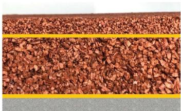
Couche de finition en LIEGE M2R 2/4 mm : env. 2 kg/m² pour 2 cm mélangé à 150 % de liant polyuréthane monocomposant MPUR Epaisseur : 20 mm - Possibilité de rajouter un vernis transparent (300 à 500 g/m²)
